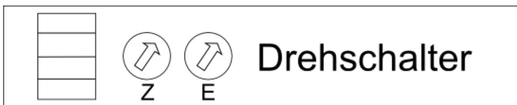
Die Einstellung erfolgt durch zwei Drehschalter auf der Unterseite des Gerätes. Mit Hilfe eines Schraubenziehers kann man einen Wert von 00 bis 99 einstellen. Wobei „Z“ für Zehner und „E“ für Einer steht. Es gilt jedoch nur der Arbeitsbereich des Moduls von 20 bis 80V!
