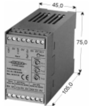
Das Modul M-S-6-12 ist eine zweiquadranten Motorsteuerung mit Sanftanlauf/Sanftbremsung für DC-Motoren. Sie gewährleistet das sichere Ein-/Ausschalten, sowie das **gesteuerte und definierte Antreiben bzw. Bremsen** von Motoren. Im Aus-Zustand wird die Last nach Ablauf der Sanftbremsung kurzgeschlossen.
