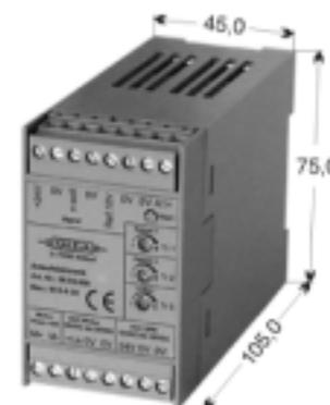
Das Modul M-S-6-xx ist eine zwei-quadranten Motorsteuerung mit Sanftanlauf/Sanftbremsung für DC-Motoren. Sie gewährleistet das sichere Ein-/Ausschalten, sowie das **gesteuerte und definierte Antreiben bzw. Bremsen** von Motoren. Im Aus-Zustand wird die Last nach Ablauf der Sanftbremsung kurzgeschlossen.
