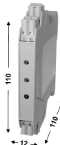
Das Modul M-MWS-6-30 ist eine Motorsteuerung für DC-Motoren mit Links-/Rechtslauf. Sie gewährleistet das sichere **Ein-/Ausschalten** sowie die **Drehrichtungssteuerung** von Motoren. Im Aus-Zustand wird die Last kurzgeschlossen, dadurch ergibt sich eine dynamische Bremsung die wahlweise Ein- / Ausgeschaltet werden kann (A3).
