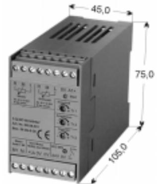
Das Modul M-2Q-6-xx ist eine zweiquadranten Motorsteuerung für DC-Motoren. Sie gewährleistet das sichere Ein-/Ausschalten, sowie das **gesteuerte Antreiben und Bremsen** von Motoren, Magnetventilen und sonstigen Lasten. Im Aus-Zustand wird die Last kurzgeschlossen, dadurch ergibt sich eine dynamische Bremsung.
