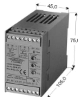
Das Modul M-2Q-6-xx ist eine zweiquadranten Motorsteuerung für DC-Motoren. Sie gewährleistet das sichere Ein-/Ausschalten, sowie das **gesteuerte Antreiben und Bremsen** von Motoren, Magnetventilen und sonstigen Lasten. Im Aus-Zustand wird die Last kurzgeschlossen, dadurch ergibt sich eine dynamische Bremsung.
