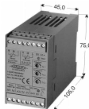
Das Modul M-2Q-6-60 ist eine zweiquadranten Motorsteuerung für DC-Motoren. Sie gewährleistet das sichere Ein-/Ausschalten, sowie das **gesteuerte Antreiben und Bremsen** von Motoren, Magnetventilen und sonstigen Lasten. Im Aus-Zustand wird die Last kurzgeschlossen, dadurch ergibt sich eine dynamische Bremsung.
