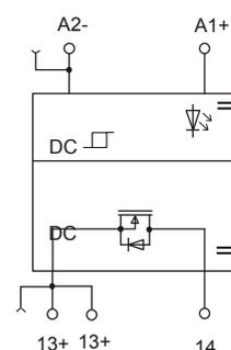
Schaltspannung: 5VDC bis 53VDC
