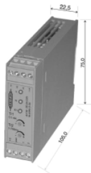
Das Modul M-MWI-5-12 ist eine zwei-quadranten Motorsteuerung für DC-Motoren. Sie gewährleistet das sichere Ein-/Ausschalten in beide Drehrichtungen von Motoren, Magnetventilen und sonstigen Lasten. Im Aus-Zustand kann die Last kurzgeschlossen werden, dadurch ergibt sich eine dynamische Bremsung.
