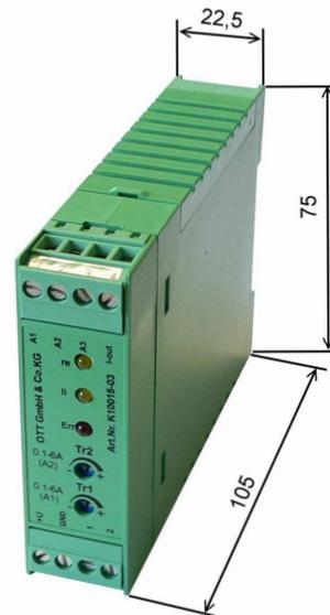
Das Modul M-MWI-6-30 ist eine zwei-quadranten Motorsteuerung für DC-Motoren. Sie gewährleistet das sichere Ein- /Ausschalten in beide Drehrichtungen von Motoren, Magnetventilen und sonstigen Lasten. Im Aus-Zustand kann die Last kurzgeschlossen werden, dadurch ergibt sich eine dynamische Bremsung
