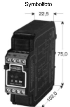
Das Modul Maxi-MR-5-30 ist eine zweiquadranten Motorsteuerung für DC-Motoren. Sie gewährleistet das sichere Ein-/Ausschalten, sowie das **gesteuerte Antreiben** von Motoren, Magnetventilen und sonstigen Lasten. Im Aus-Zustand kann die Last kurzgeschlossen werden, dadurch ergibt sich eine dynamische Bremsung.
