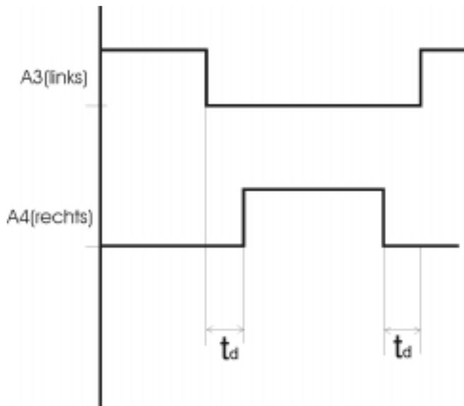
**Achtung:** Beim überschneiden von A3=high und A4=high kann am Ausgang ein undefinierter Zustand auftreten. Bei der Ansteuerung muss auf entsprechende Einhaltung einer Verzögerung geachtet werden.
