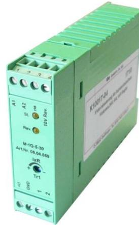
Das Modul Maxi-1Q-5-30 ist eine Einquadranten Motorsteuerung für DC-Motoren mit Links-/Rechtslauf. Sie gewährleistet das sichere Ein-/Ausschalten sowie die Drehrichtungssteuerungen von Motoren. Die Drehzahlregelung kann über eine SPS (0-10V) oder ein Potentiometer erfolgen.
