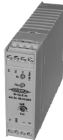
Das Modul M-1Q-1-30 ist eine einquadranten Motorsteuerung für DC-Motoren mit Links-/Rechtslauf. Sie gewährleistet das sichere Ein-/Ausschalten sowie die Drehrichtungssteuerung von Motoren. Die Drehzahlregelung kann über eine SPS (0-10VDC) oder einem Potentiometer erfolgen.
