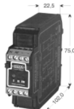
Das Modul Maxi-R-6-30 ist eine Motorsteuerung mit Sanftanlauf/Sanftbremsung für DC-Motoren. Sie gewährleistet das sichere Ein-/Ausschalten, sowie das **fest eingestellte Antreiben und Bremsen** von Motoren, Magnetventilen und sonstigen Lasten. Im Aus-Zustand ist die dyn. Bremsung wirksam.
