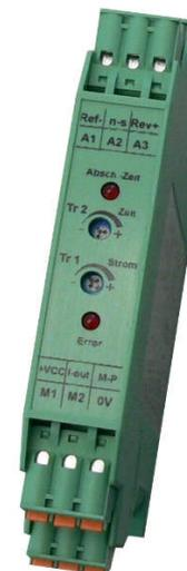
Das Modul M-MRI-3-30 ist eine zweiquadranten Motorsteuerung für DC-Motoren. Sie gewährleistet das sichere Ein-/Ausschalten in beide Drehrichtungen von Motoren, Magnetventilen und sonstigen Lasten. Im Aus-Zustand wird die Last kurzgeschlossen werden, dadurch ergibt sich eine dynamische Bremsung.
