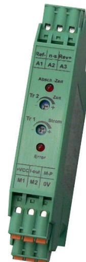
Das Modul M-MRI-1-30 ist eine zweiquadranten Motorsteuerung für DC-Motoren. Sie gewährleistet das sichere Ein-/Ausschalten in beide Drehrichtungen von Motoren, Magnetventilen und sonstigen Lasten. Im Aus-Zustand wird die Last kurzgeschlossen werden, dadurch ergibt sich eine dynamische Bremsung.
