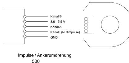
Bitte beachten Sie unbedingt das Anschlussdiagramm, da ansonsten der Motor und die Elektronik Schaden nehmen können.
