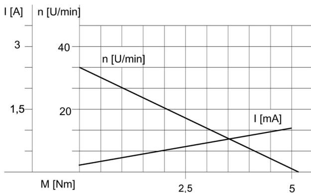
Motordiagramm 12 V
